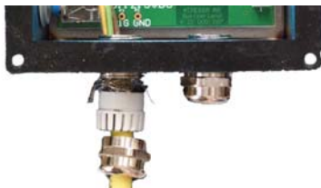
Durchgängige Erdung mit Einbindung eines Gehäuses über den Schirm
